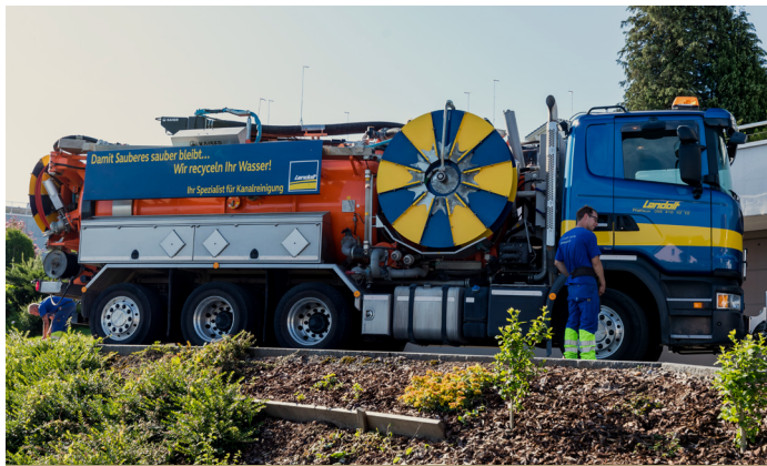
Mit den Spül-/Saugwagen werden Verschmutzungen aus Schächten und Klärgruben entfernt.
