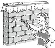
Das Mauerwerk darf nicht belastet werden, bevor der Mauermörtel abgebunden und der charakteristische Wert der Mörteldruckfestigkeit 70 % erreicht hat.
