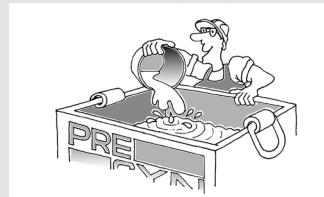
Bei der Lagerung des Presyn Mörtels ist darauf zu achten, dass die glatt gestrichene Mörteloberfläche mit Wasser bedeckt ist.
